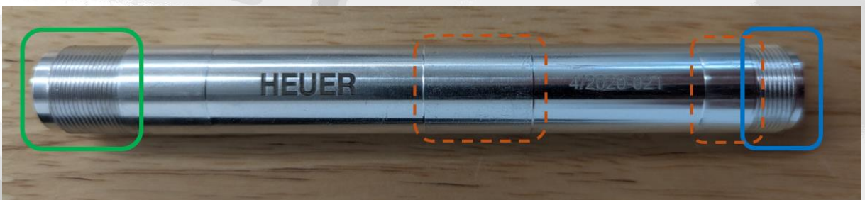
Hinterradachse – Losanschlag links
